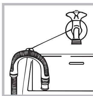
o apóyelo en el borde de un lavamanos o de una bañera, uniendo la guía suministrada con el aparato, al grifo (*ver la figura*). El extremo libre del tubo de descarga no debe permanecer sumergido en el agua.
